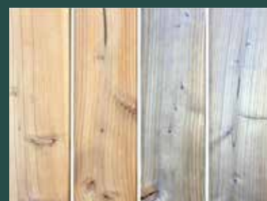
Douglas 1x behandeld na ca. 3 maanden. Douglas onbehandeld na ca. 3 maanden.
